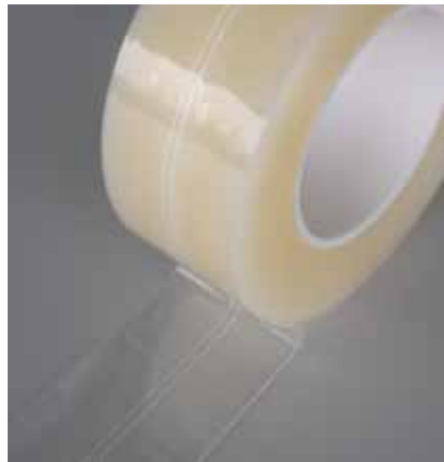
Das Lagerband ist doppelt perforiert. Die eine Seite klebt an der Schaltafel, die andere hält am Deckenlager.
